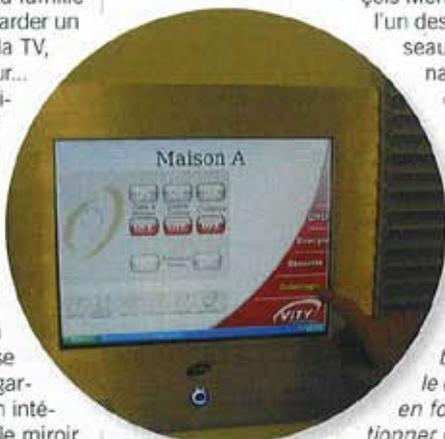
Il permet de gérer l'installation domotique (chauffage, éclairage...) mais aussi les caméras, l'infra rouge en lançant un DVD, en gérant la diffusion sonore.
